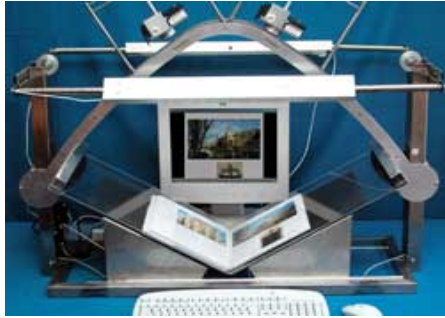
Escaner Bressol para la digitalización de material encuadernado
