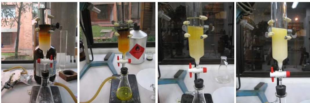
Figura 13. Cromatografía líquida de vacío en Columna, Extracto en Petrol, Hojas. Fotos tomadas por el autor.
