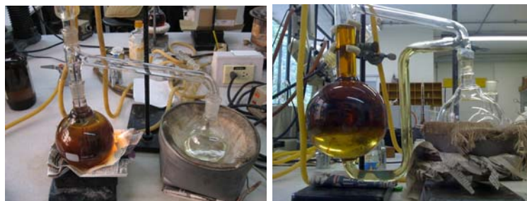
Figura 3. Equipos de Fraccionamiento. Fotos tomadas por el autor. A: Equipo de fraccionamiento para solventes menos densos que el agua. B: Equipo de fraccionamiento para solventes mas densos que el agua.
