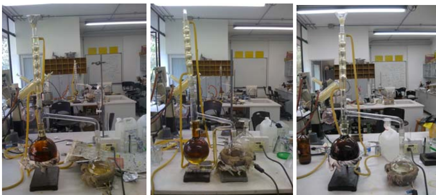
Figura 15. Fraccionamientos continuos liquido-liquido de los extractos en Etanol. Fotos tomadas por el autor.
