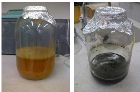
Figura 11. Floculación de Extractos en Petrol y en Etanol (Hojas y Corteza). Fotos tomadas por el autor.
