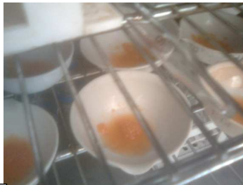
Lunes 5 Abril Levado a Horno a 99 °C para Humedad
