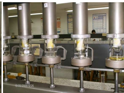
Jueves 15 Abril Llevado de las muestras de fruto industrial a humedad y Extracción de Grasa
