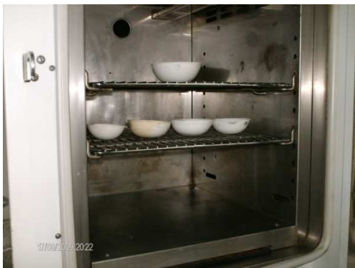
Jueves 15 Abril Llevado de las muestras de fruto industrial a humedad y Extracción de Grasa
