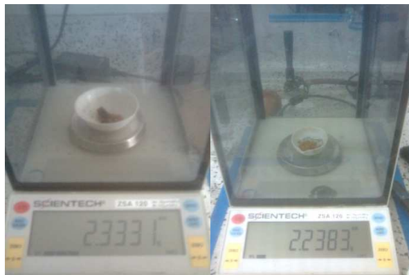
Pesado de muestras de Uchuva deshidratada Industrialmente y con levadura
