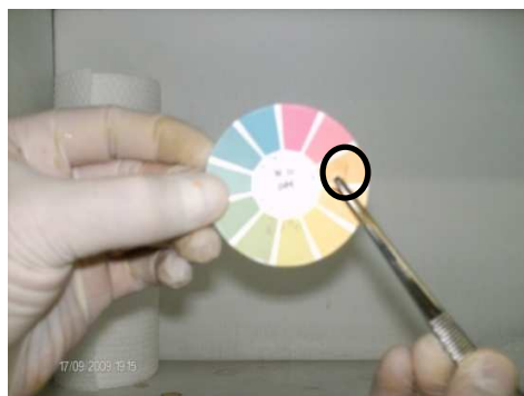
Foto 2. Determinación de pH por medio de papel indicador universal.
