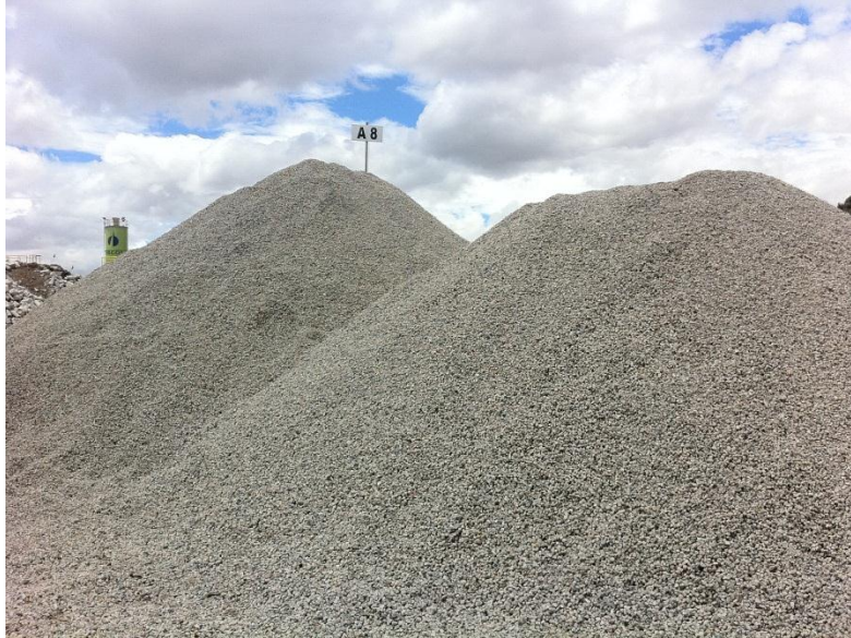
Figura 14 Pilas de agregado producto de la trituración de concreto.
