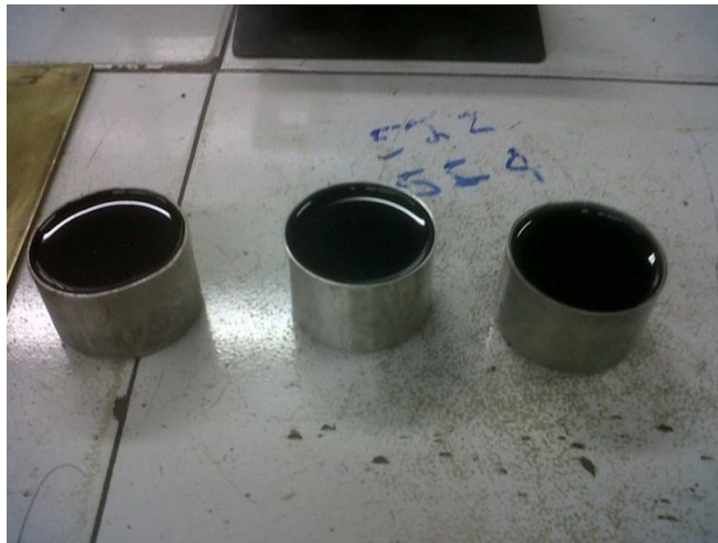
Fotografía 2 Preparación muestras para ensayo de penetración según normas INV E 706-07
