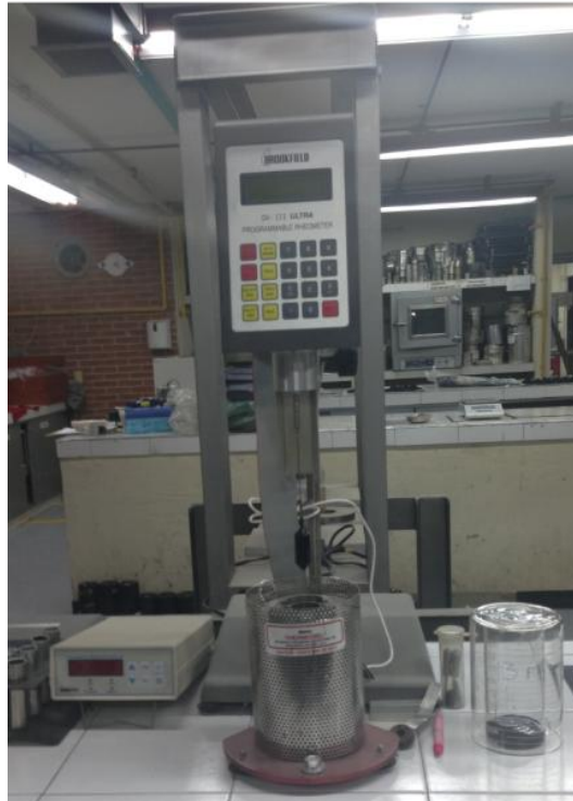
Fotografía 6 Viscosímetro Rotacional según norma INV E 717-07
