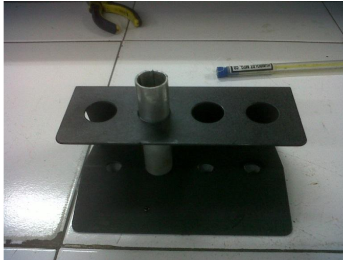
Fotografía 5 Molde para ensayo de viscosidad Brookfield según norma INV E 717-07
