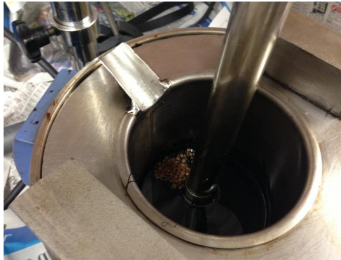
Fotografía 15 Procedimiento de mezclado con REDISSET™ WMX
