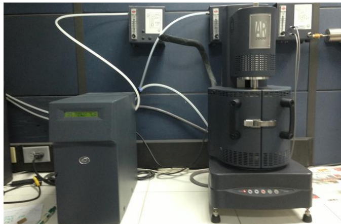
Fotografía 7 Reómetro dinámico de corte DSR de la Pontificia Universidad Javeriana
