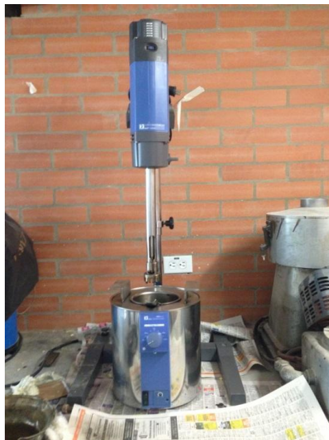
Fotografía 13 Equipo modificador- K ULTRA-TURRAX® T50 Basic IKA®- WERKE
