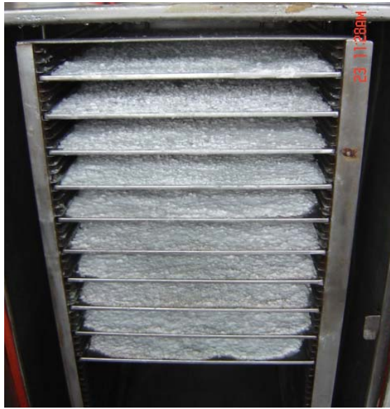
Figura 17. Disposición de las bandejas durante la fermentación sólida 7. Distancia entre bandejas: 6cm.
