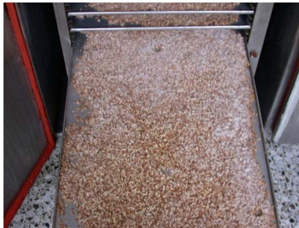
Figura 20. Efecto de la aireación en las fermentaciones sólidas 11 y 12. Caudal de aire: 0. 58vvm.
