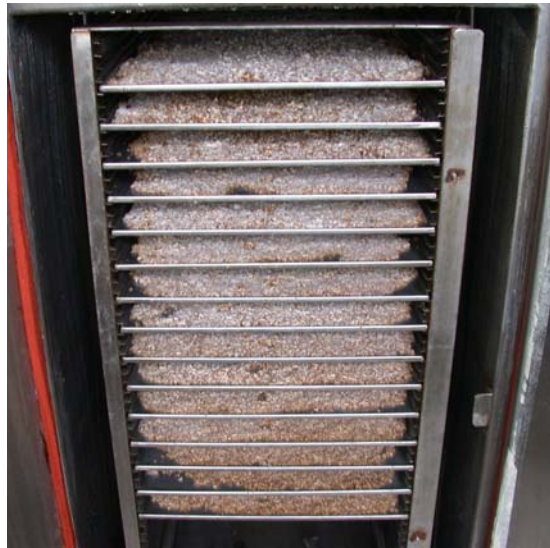
Figura 18. Disposición de las bandejas durante la fermentación sólida 2. Distancia entre bandejas: 4cm.
