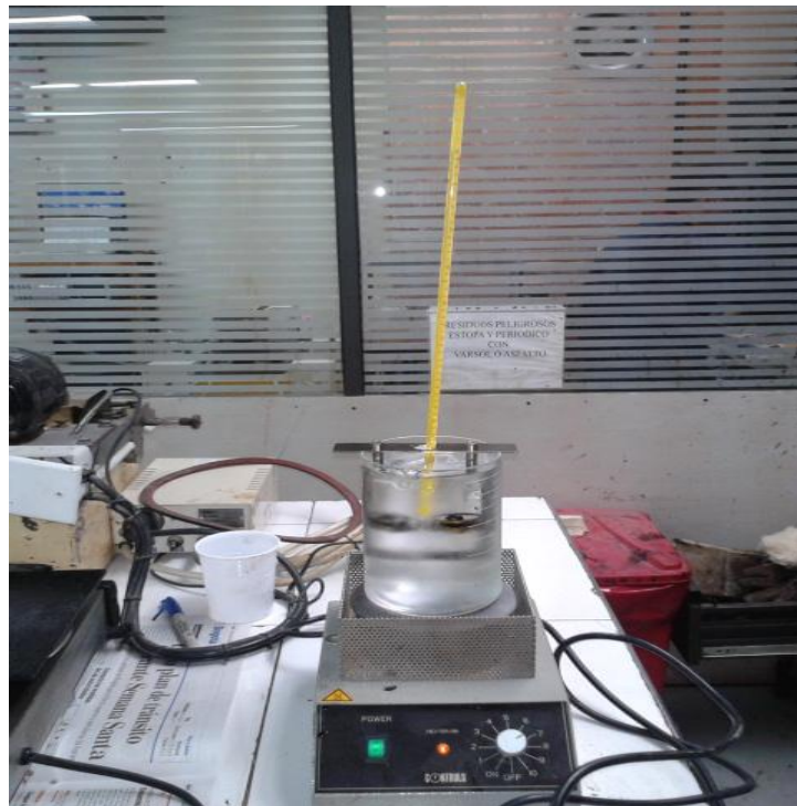
Figura 10. Montaje ensayo punto de ablandamiento. Pontificia Universidad Javeriana.
