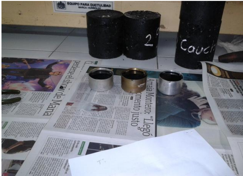
Figura 8. Montaje ensayo de penetración. Pontificia Universidad Javeriana.
