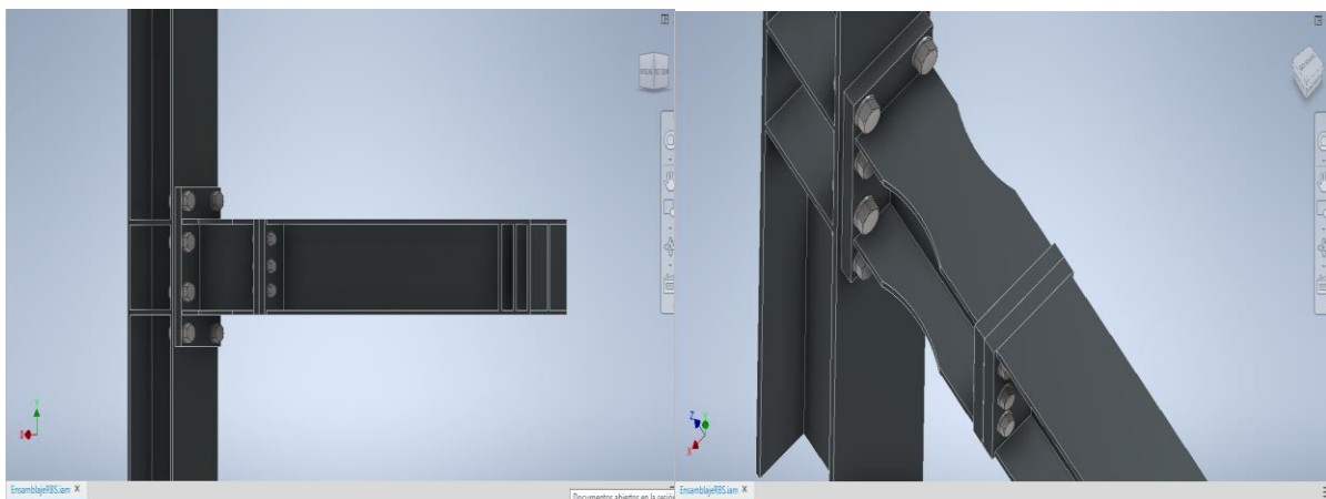
Ilustración 11 - Ensamble RBS de sección reducida. Autodesk – Inventor.
