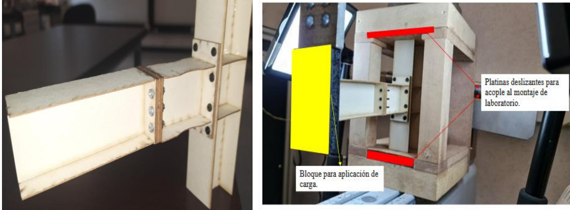
Ilustración 17 - Ensamble RBS Desmontable. Montaje Final Maquina INSTRON 5900
