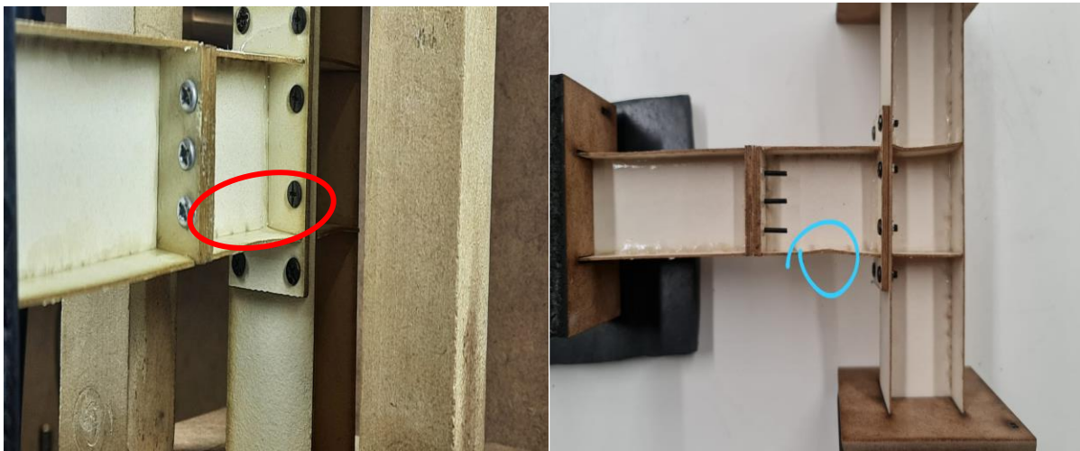
Ilustración 18 - Fallas obtenidas en laboratorio RBS Desmontable
