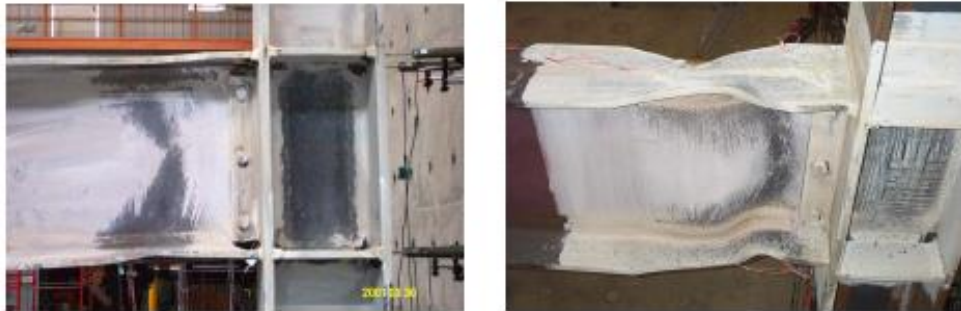
Ilustración 3 - Fallas presentadas en elementos tipo RBS
