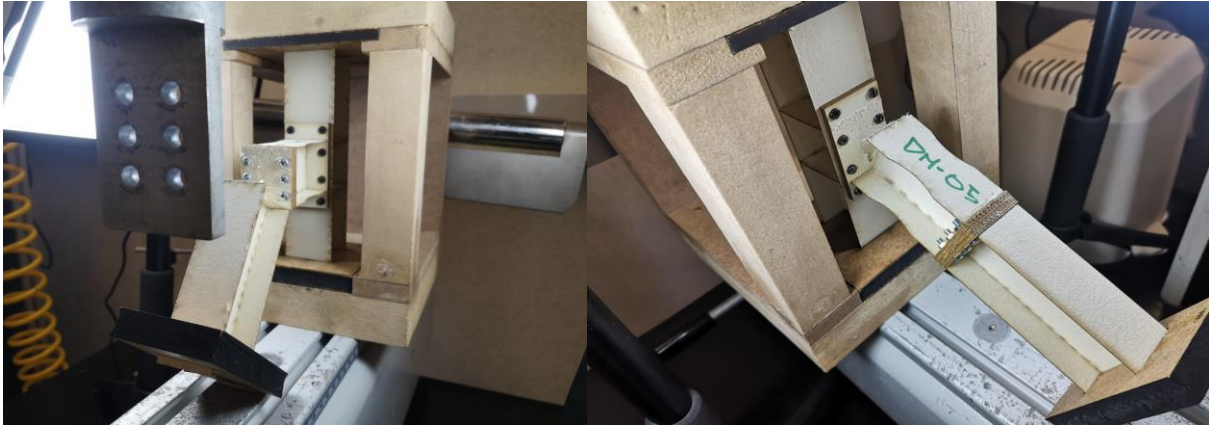
Ilustración 19 – Ruptura Material Base
