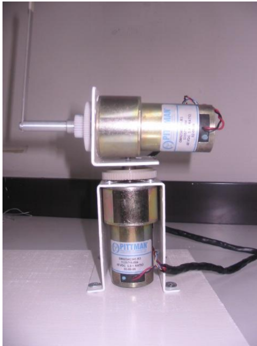
Montaje mecánico de dos grados de libertad para control de posición.
