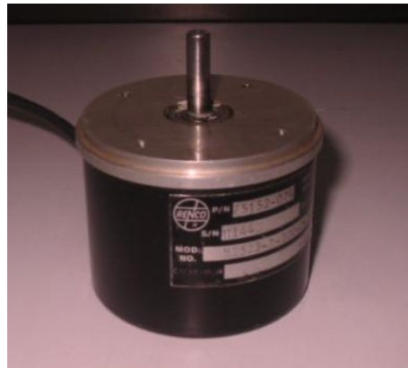
Figura 5.10. Encoder Incremental de la casa RENCO CORP , utilizado para prueba con el sistema de medición angular.
