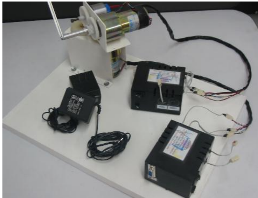
Hardware en detalle: cada una de las dos cajas contiene un sistema de medición angular, uno por cada grado de libertad.
