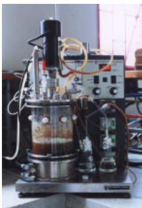
Figura 10. Fermentador BIOFLO III utilizado para la fermentación de 3 litros
