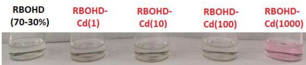
Figura 45. Colorimetría de la solución RBOHD (70-30%) a pH 3.75 con concentraciones de Cd a 1-10-100-1000µg/l.
