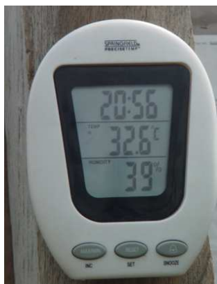
Figura 8. Termohigrómetro . en la parte superior se observa la hora, en la parte media la temperatura y en la parte de abajo la humedad relativa. (Foto: Perilla y Sanabria (2007)).
