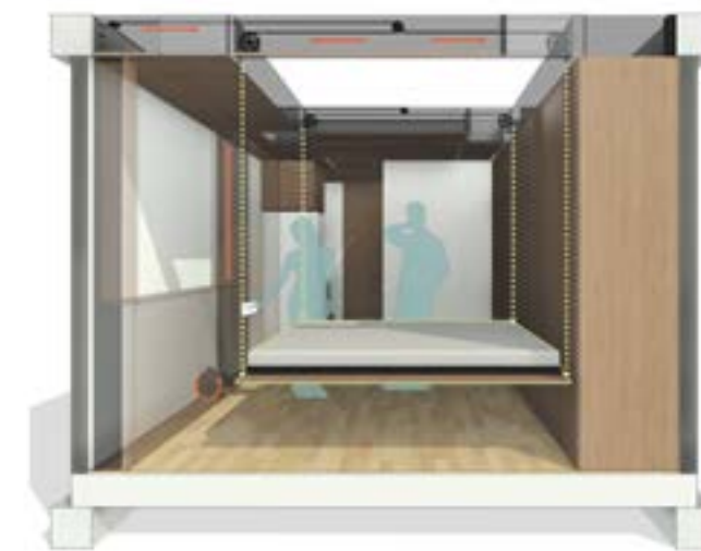
Figura N.º 33 Sistema - bajando base cama - Versutil - año 2024 - fuente propia
