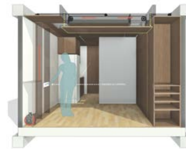
Figura N.º 33 Sistema - bajando base cama - Versutil - año 2024 - fuente propia
