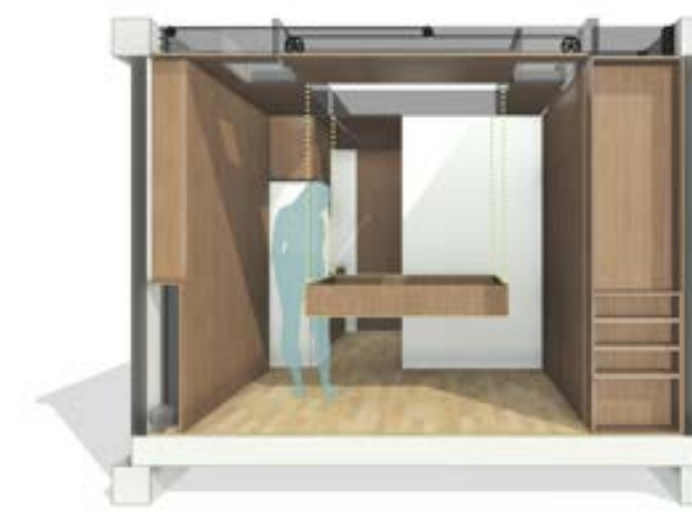
Figura N.º 34 Sistema - bajando almacenaje - Versutil - año 2024 - fuente propia
