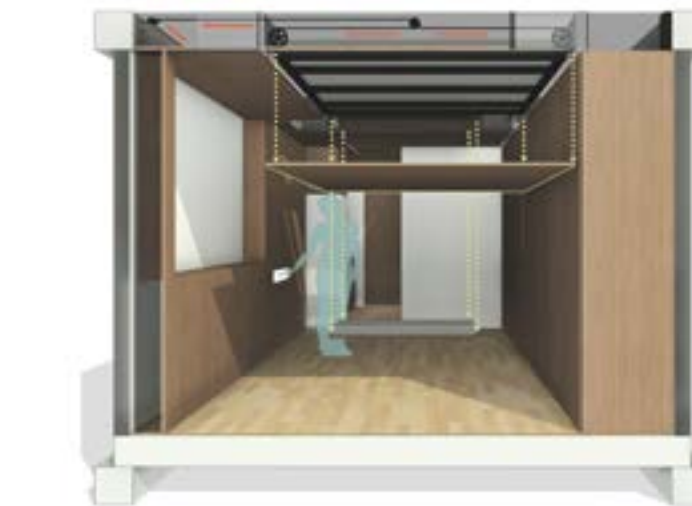
Figura N.º 34 Sistema - bajando almacenaje - Versutil - año 2024 - fuente propia
