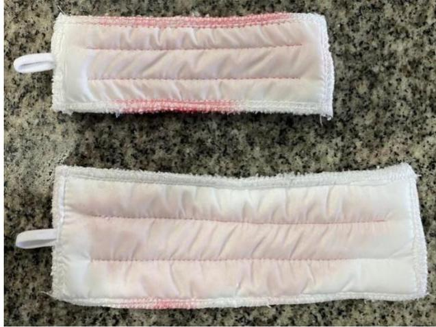
El prototipo arrojó que los pads deben hacerse con fibra de Bambú para que sean reutilizables, doble acanalado vertical, con un número de capas entre 1 y 4 y con tela anti fluido en su parte trasera.
