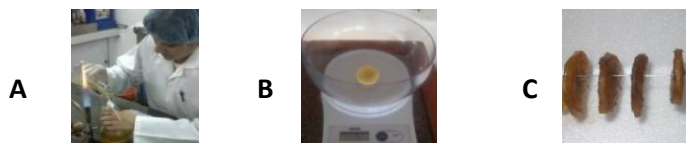
Fig. 3 Tratamiento del banano con la levadura: preparación de la inmersión del banano en la levadura. A. preparación de la levadura. B pesajes de las rodajas de banano. C. bananos luego de la inmersión, colgados con alambre inoxidable.
